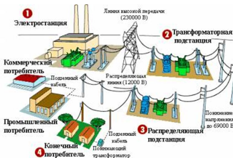
Рис. 1. Принцип работы питающей сети
