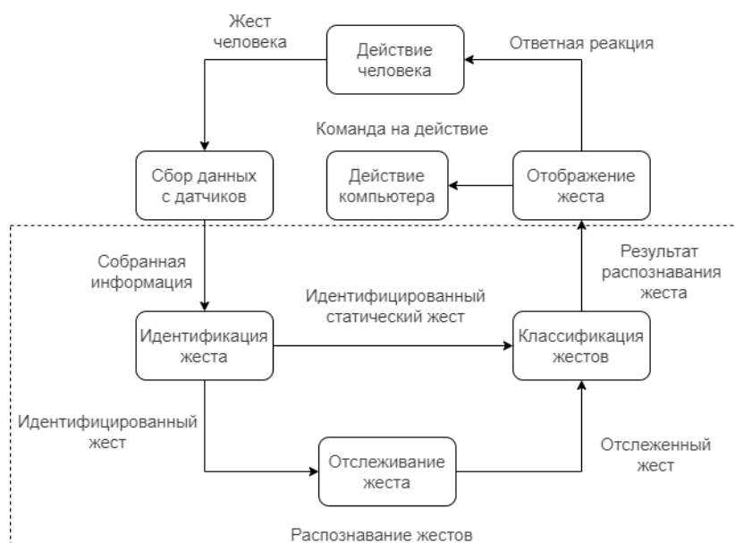
Рис. 2. Процесс распознавания жестов при взаимодействии человека и компьютера
